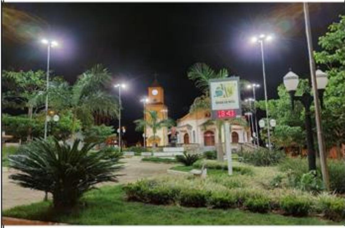
4- Instalado 16 postes novos (Aço) e instalado 64 luminárias de LED 100w
